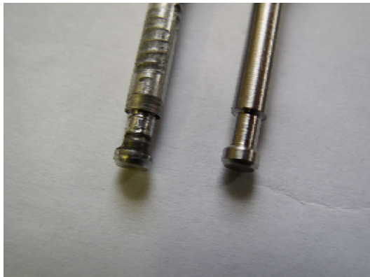
Рисунок 3 — Фотографії руйнувань деталей клапана з двопозиційним електромагнітним приводом
