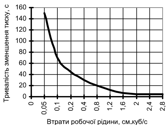
Рисунок 6 — Залежність часу (тривалості) зменшення тиску робочої рідини в порожнині гідроциліндра \Delta t_2 з 10 МПа до 5 МПа від втрат робочої рідини \Delta Q_2 в спряженнях корпус-золотник розподільника та поршня з корпусом і штоком гідроциліндра. Золотник розподільника встановлено в позицію "Нейтральна".
