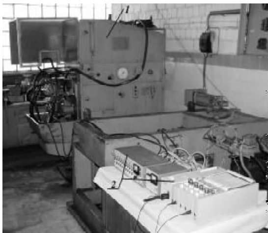
Рисунок 3 — Експериментальне обладнання 1 — стенд КИ-1774 для випробування гідроприводів; 2 — підсилююча та реєструюча апаратура.
