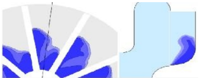
Рисунок 14 Розвиток кавітаційної зони в робочому колесі СВН
