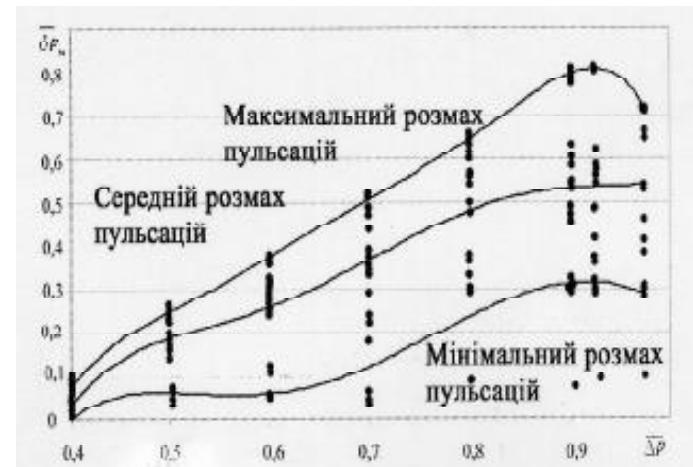
Рисунок 15 — Залежність розмаху безрозмірного тиску  $\overline{\delta p}_m$  від безрозмірного перепаду тиску  $\overline{\Delta p}$  для конфузорно-дифузорного насадка ( $p_{\text{вх}} = 10 \text{ МПа}$ )
