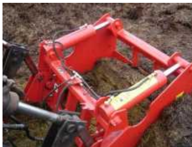
Рисунок 1 — Вирізаючий механізм “алігаторного” відкусуючого типу з приводом робочого органа від гідроциліндрів: 1 — рама, 2 — вила, 3 — ніж, 4 — вісь, 5 — гідроциліндр, 6 — П-подібна рамка
