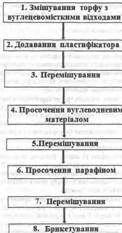
Рисунок 1 — Блок-схема процесу брикетування торфу
