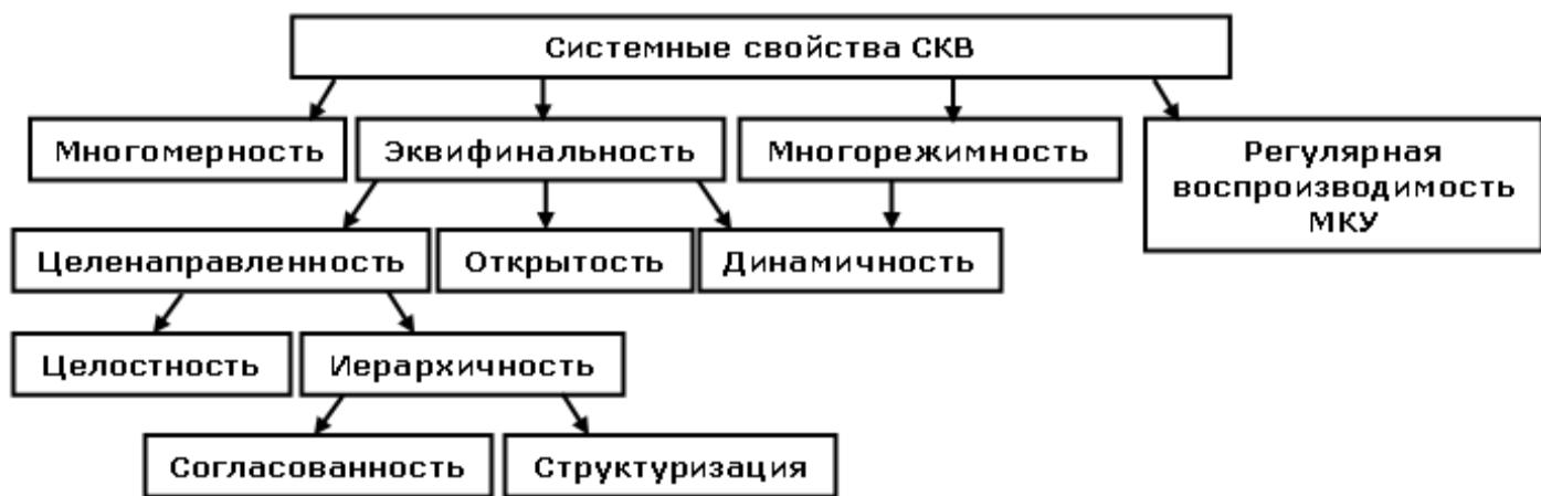
Рисунок 2 — Системные свойства, характеризующие системы кондиционирования воздуха в целом.
