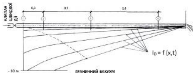
Рисунок 2 — Зміна п'єзометричних ліній при сповільненні потоку
