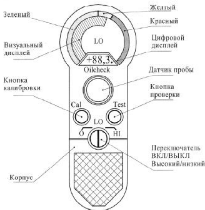
Рисунок 9 — Переносной монитор (индикатор) состояния масла модели Oilcheck фирмы "Parker"
