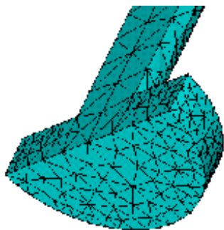
Рисунок 15 — Кінцевоелементна розбивка торця штока (сідла) до згущення
