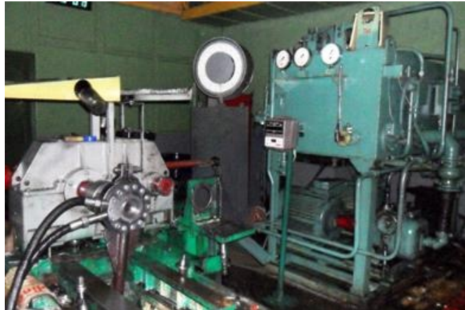
Рисунок 1 — Стенд для испытания гидравлических вращателей планетарного типа
