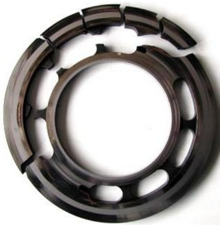
Рисунок 1 — Характер разрушения распределителей аксиальнопоршневой гидромашины: а — линзовый (материалы ОАО "Стройгидравлика"), б — плоский [6].
