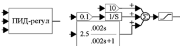
Рисунок 7 — ПИД-регулятор внутреннего контура и каналы настройки
