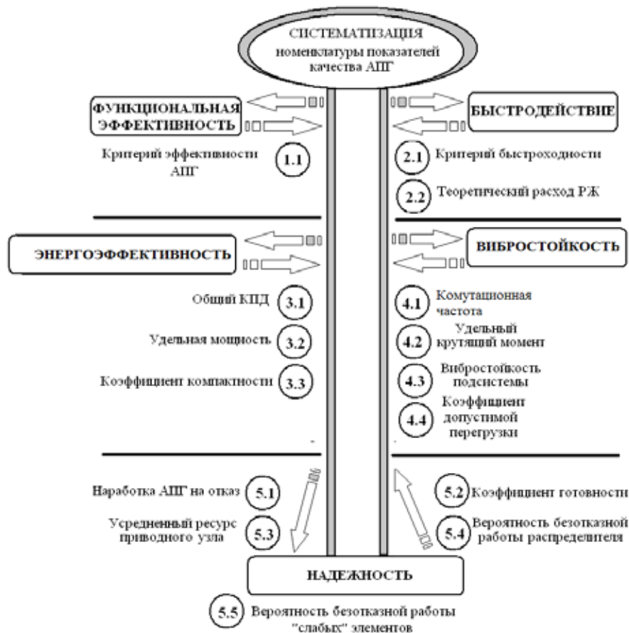
Рисунок 2— Схема квалиметрической модели технического уровня аксиально-поршневого гидропривода
