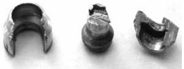
Рисунок 2 — Примеры пластической деформации и разрушения стопорной шайбы 14 и шейки штока 3
