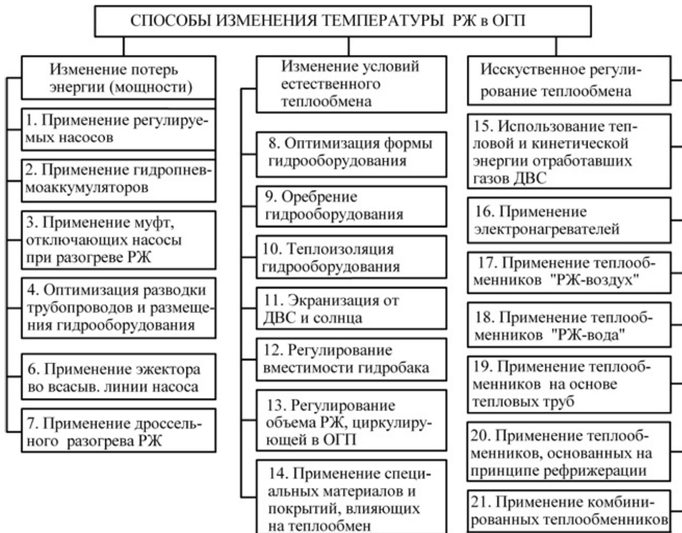
Рисунок 4 — Способы изменения температуры рабочей жидкости в объемном гидроприводе [6]
