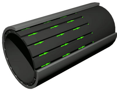
Рисунок 1 — Водяне охолодження крізь канали у роторі (1-а схема)
