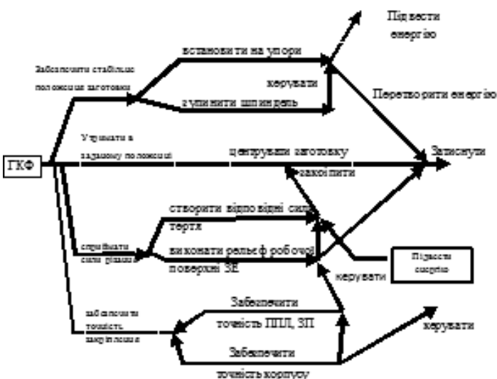
Рисунок 3 — Ієрархічна функціональна модель затискного патрона
