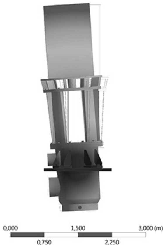
Рисунок 2 — Форма колебаний конструкции насосного агрегата слива сепарата, соответствующая второй собственной частоте колебаний
