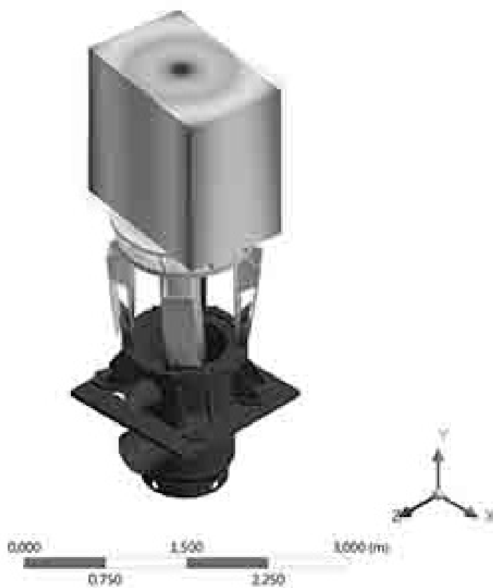
Рисунок 6 – Формы колебаний конструкции насосного агрегата слива сепарата
