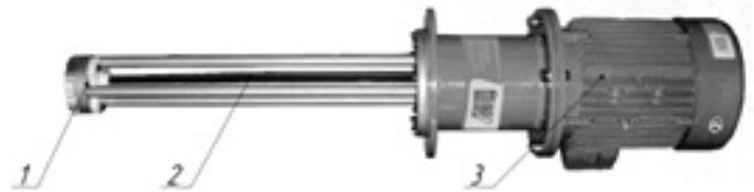
Рисунок 3 — Зображення безкорпусного роторно-пульсаційного апарата [14]: 1 — генератор пульсацій; 2 — приводний вал; 3 — електродвигун.
