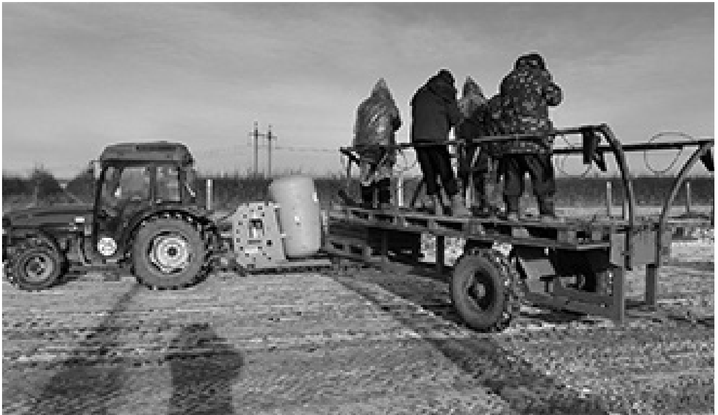
Рисунок 1 — Мобільний агрегат для обрізки саду
