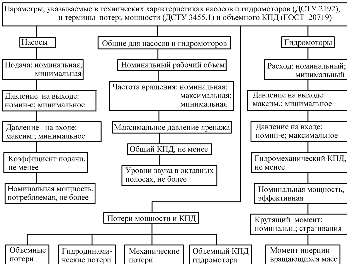
Рисунок 17 — Параметры насосов и гидромоторов
