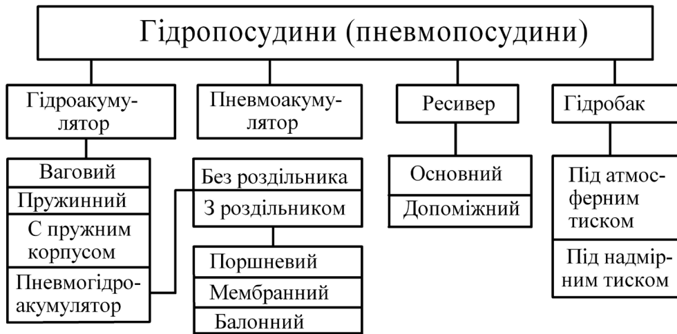
Рисунок 12 — Классификация гидроэластичностей объемных гидроприводов
