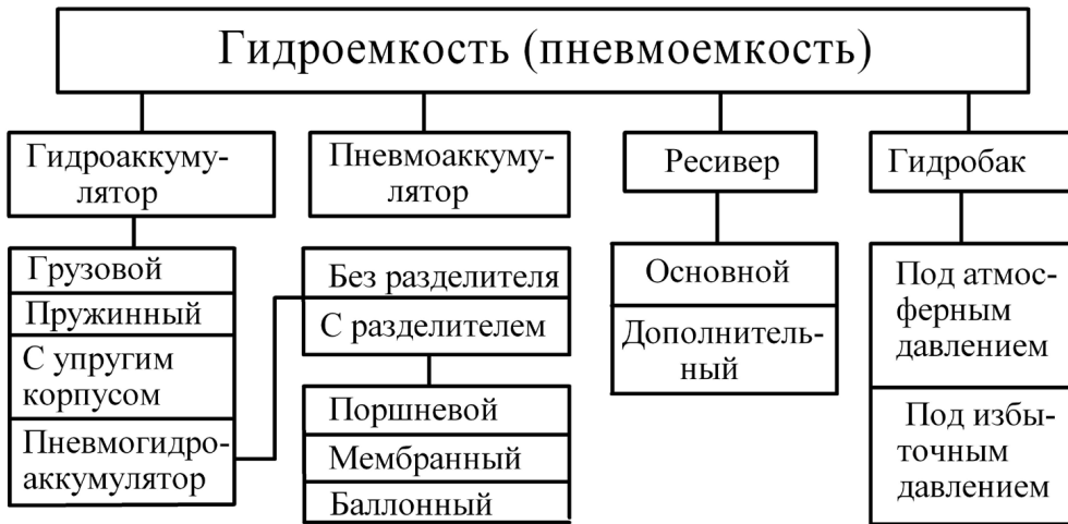
Рисунок 11 — Классификация гидроэластичностей объемных гидроприводов
