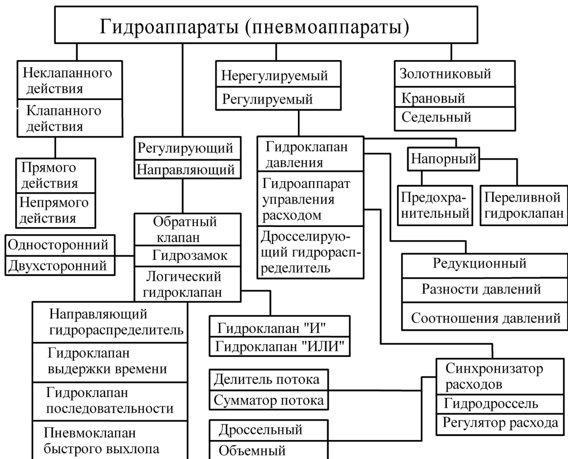
Рисунок 9 — Классификация гидроаппаратуры (пневмоаппаратуры) [3]
