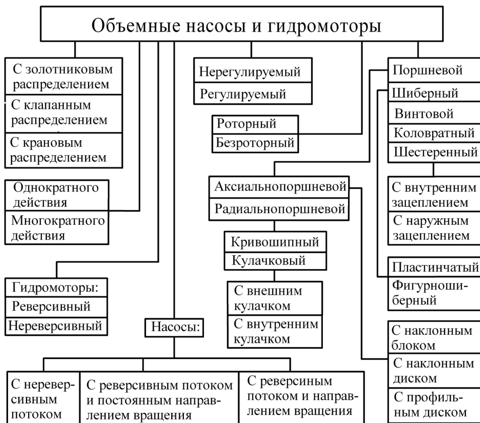
Рисунок 5 — Классификация объемных насосов и гидромоторов
