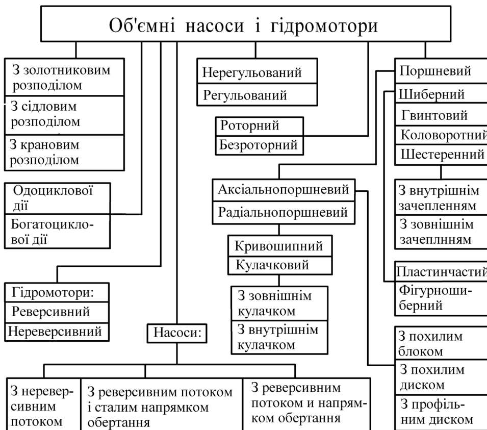
Рисунок 6 — Загальна класифікація об'ємних насосів і гідромоторів
