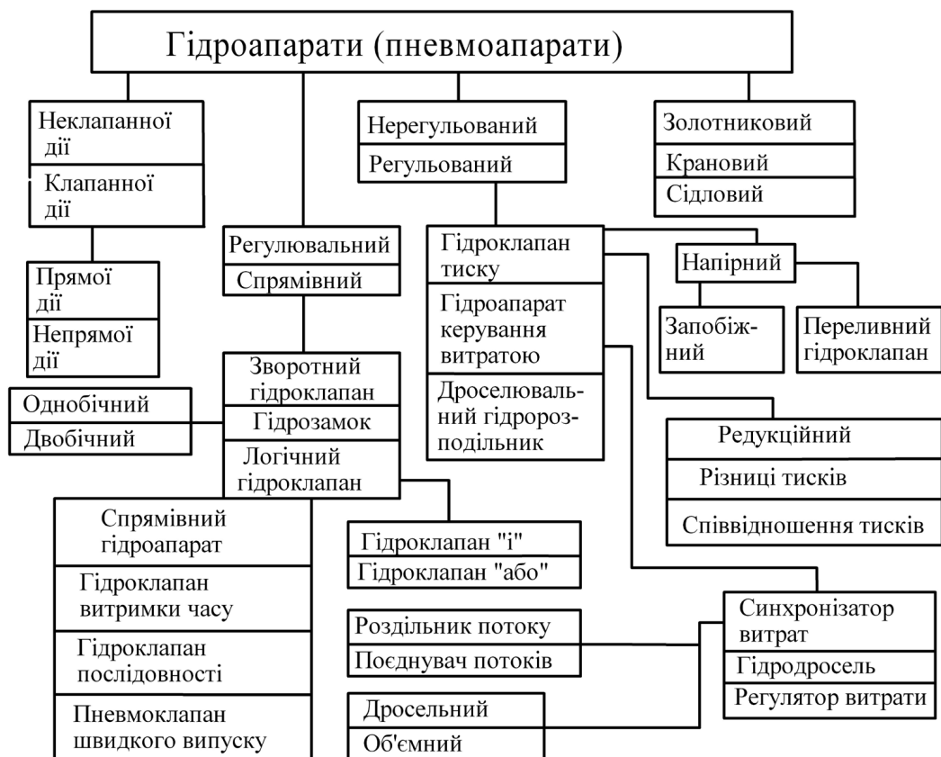
Рисунок 10 — Классификация гидроаппаратуры (пневмоаппаратуры) [3]
