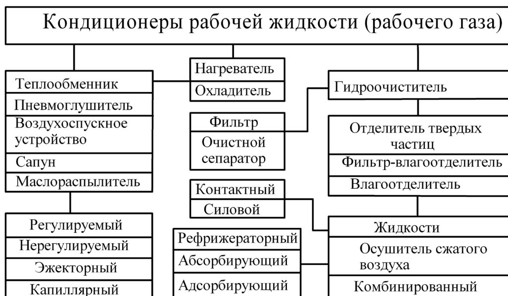
Рисунок 15 — Класифікація кондиціонерів робочої жидкості
