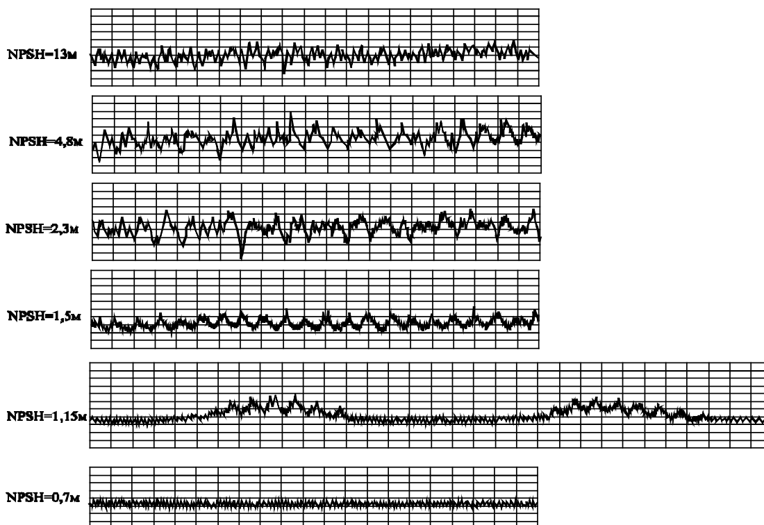
Рисунок 2 — Серия осциллограмм пульсаций входного давления на номинальной подаче Q_{ном} = 0,05 \text{ м}^3/\text{с} в шнекоцентробежной ступени с предвключенным колесом традиционной конструкции
