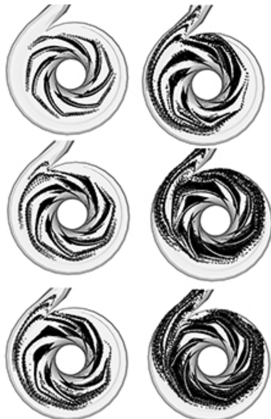
Рисунок 3 — Развитие вихревого следа за лопастями за один оборот рабочего колеса центробежного насоса
