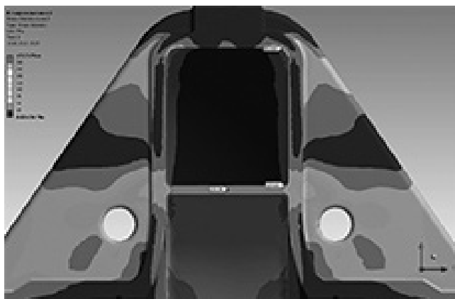
Рисунок 9 — Интенсивность напряжений в вертикальном сечении крышки, вариант модели 3 (5-5), МПа
