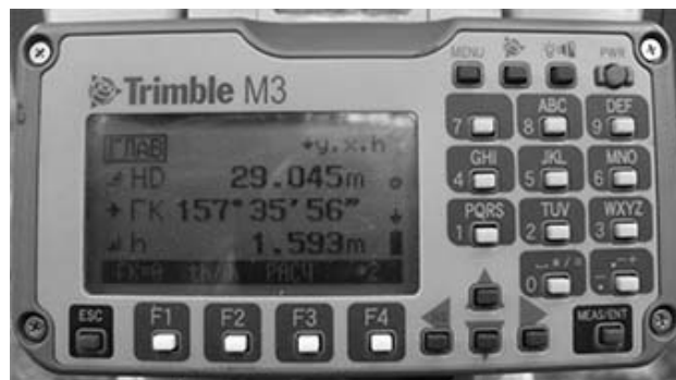
Рисунок 4 — Загальний вигляд екрана та клавіатури керування тахеометра: HD — горизонтальна відстань від тахеометра до мірної точки, м, GK — горизонтальний кут, град, \Delta h — перевищення (м) між точкою встановлення тахеометра та мірною точкою
