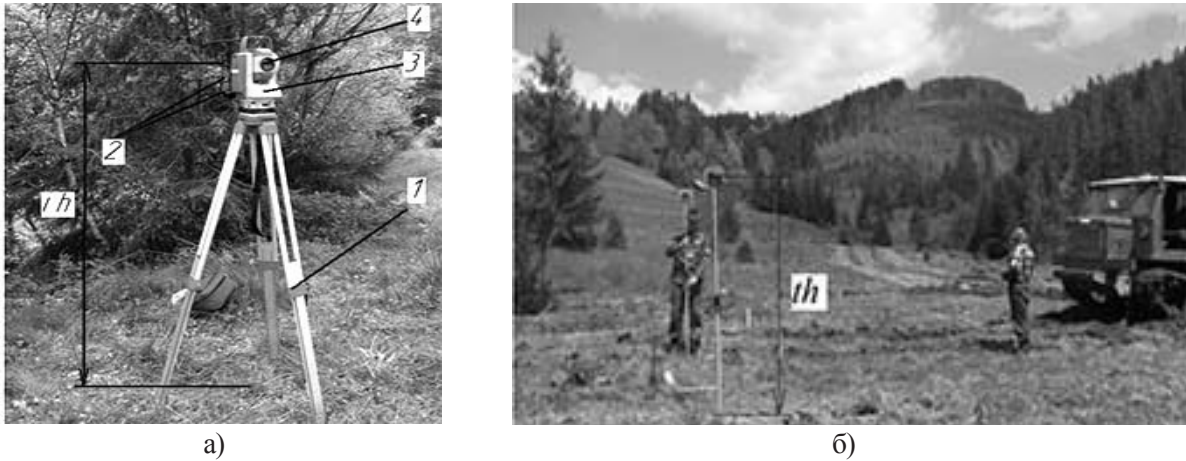
Рисунок 3 — Загальний вигляд тахеометра Trimble M3 (а) і призми (б), які встановлені на дослідній ділянці для реєстрації глибини колії: 1 — штатив, 2 — тахеометр, 3 — гвинти наведення тахеометра, 4 — об'єктив тахеометра, ih — висота встановлення тахеометра, th — висота встановлення призми ( th = 2,15 м)
