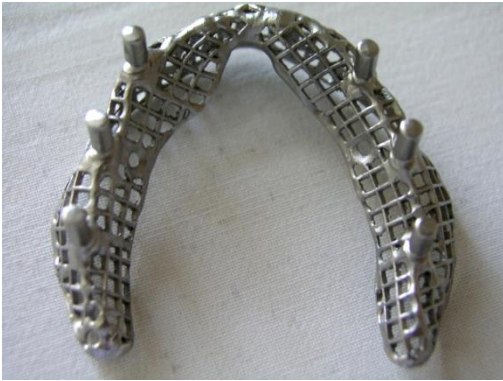
Рис. 20. Литевая конструкция субпериостального имплантата перед окончательной обработкой и пассивацией.
