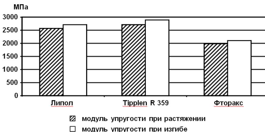
Рис. Результаты исследования модулей упругости основных базисных пластмасс
