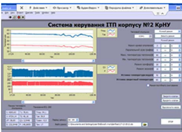
Рисунок 11 – Вікно програми керування індивідуальним тепловим пунктом навчального корпусу № 2
