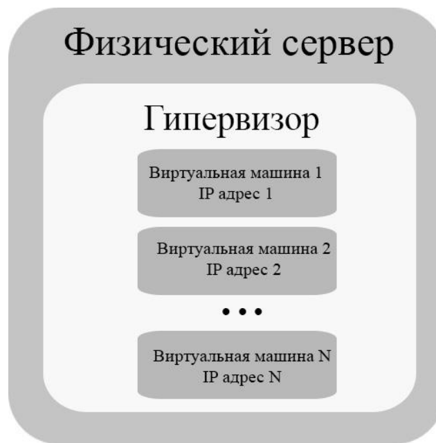
Рис. 5. Гипервизор, установленный на сервере
