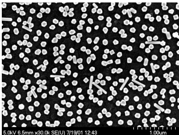
Рис. 1 – Зображення наночастинок срібла, отримане за допомогою сканувального електронного мікроскопа
