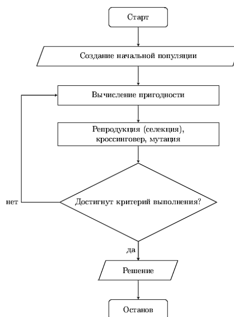
Рис. 3 – Блок-схема генетического алгоритма
