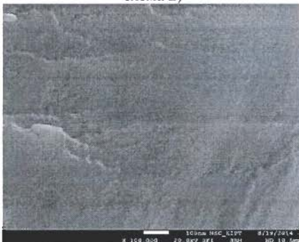
Покрyтие, полученное при T_{oc} = 500-530^\circ\text{C} (обр. № 425; схема 2)
