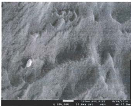
Покрyтие, полученное при T_{oc} = 430-400^\circ\text{C} (обр. № 427; схема 2)
