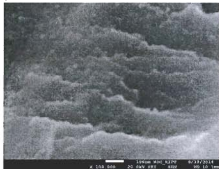
Покрyтие, полученное при T_{oc} = 445-465^\circ\text{C} (обр. № 428; схема 2)
