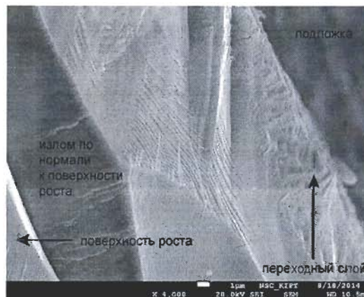
Рис. 14. Вид излома карбидохромового покрытия под разными углами к поверхности роста.
