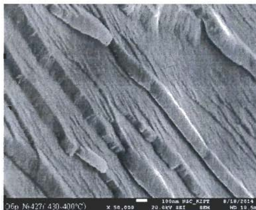
Рис. 15. Увеличенный фрагмент излома карбидохромового покрытия со ступенями излома
