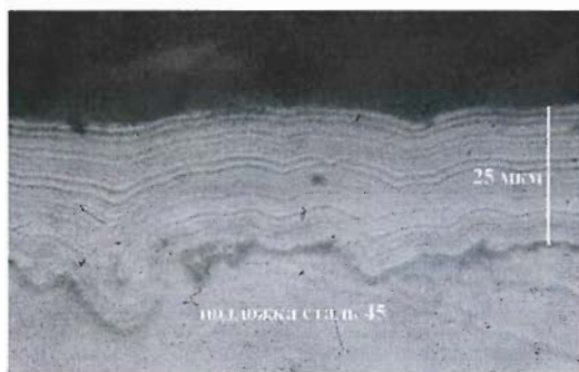
Рис. 3. Структура покрытия, полученная в стальном реакторе T_{oc} = 490–500 ^\circ C (обр. № 426) и встроенном реакторе \varnothing 60 мм
