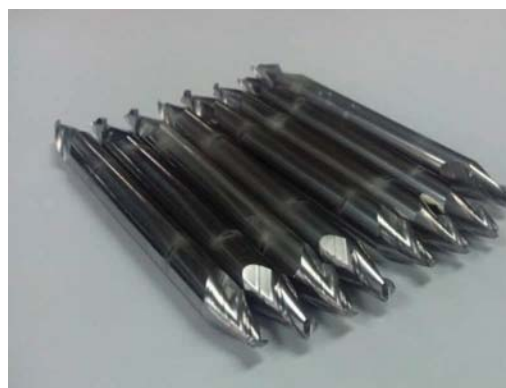
Рис. 9. Конусная фреза с многослойным вакуумно-дуговым покрытием MoN/CrN
