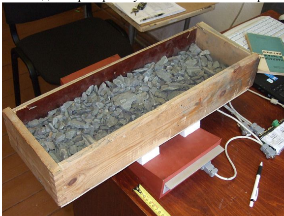
Рис. 12. Физическая модель «датчик-рудопоток» для исследования влияния расстояния до потока и смещения потока
