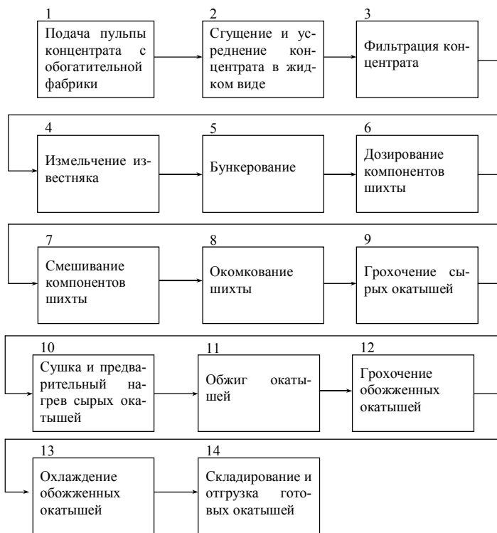
Рис. 1. Функциональная схема формирования окатышей
