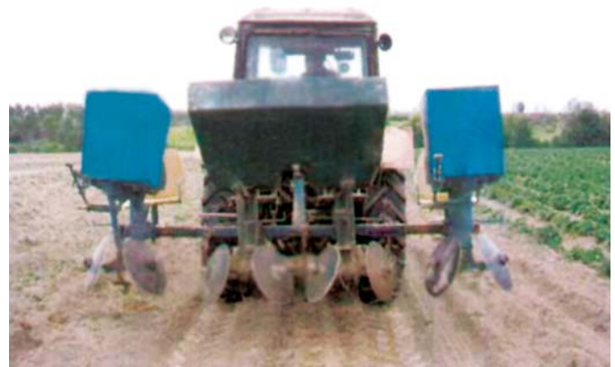
Рис. 1. Картоплезаджалка комбінована (загальний вид) та технологічний процес садіння картоплі
