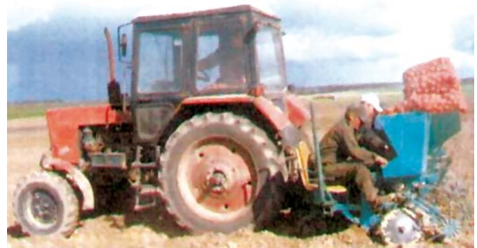
Рис. 1. Картоплезаджалка комбінована (загальний вид) та технологічний процес садіння картоплі
