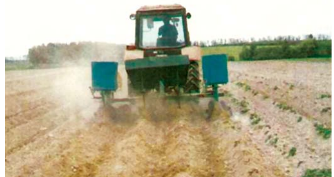
Рис. 2. Агрегат і технологічний процес міжрядного обробітку картоплі
