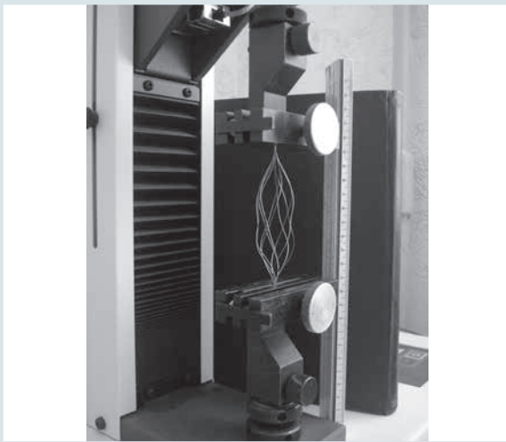
Рис. 7. Фото кава-фільтра в розривній машині HOUNSFIELD
