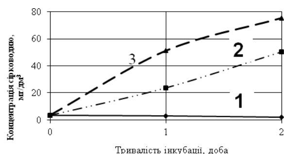
Рис. Влияние температуры на накопление H_2S в сточных водах: 1 - 6^{\circ}C , 2 - 17^{\circ}C , 3 - 28^{\circ}C
