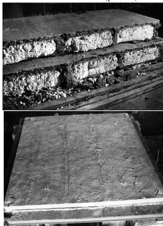
Рис. 2.5. Эффективная сборная панель перекрытия.
