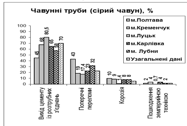
Рис. 1 – Діаграми причин пошкоджень чавунних водопровідних труб
