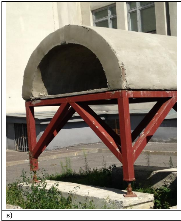
Рис. 10. Изготовление стенда для проведения испытаний: а- ячеистая система.; б- образующие резервуар щиты; в- каркас для испытаний
