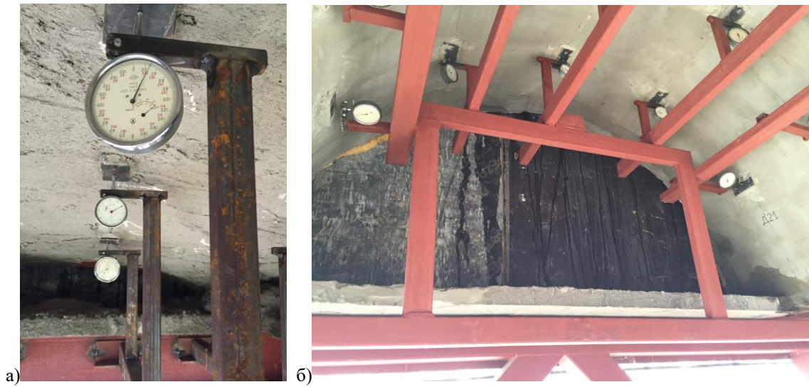
Рис. 11. Система вимірювання: а- індикатор годинного типу; б- каркас кріплення приладів.
