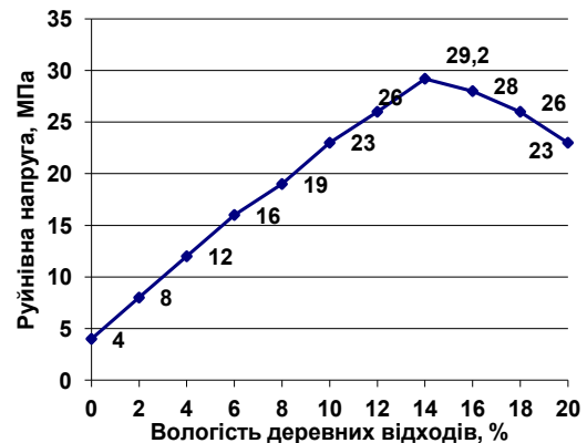
Рис.2 - Залежність руйнівної напруги брикетів при вигинанні від вологості деревних відходів.
