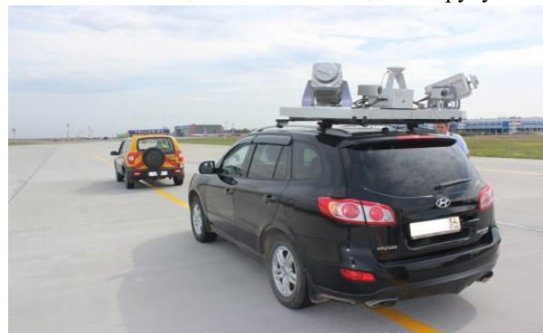
Рис. 4. Виконання зйомки мобільним лазерним сканувальним пристроєм
