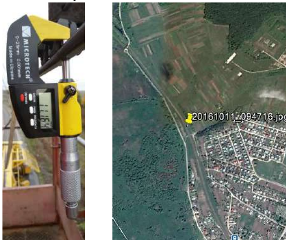
Рис. 1.1 – Фотографія виміру висоти контактної проводу з фіксацією координат по GPS.
