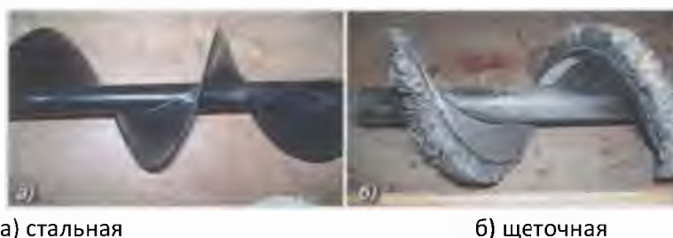
Рис. 8. Винтовая поверхность шнека
