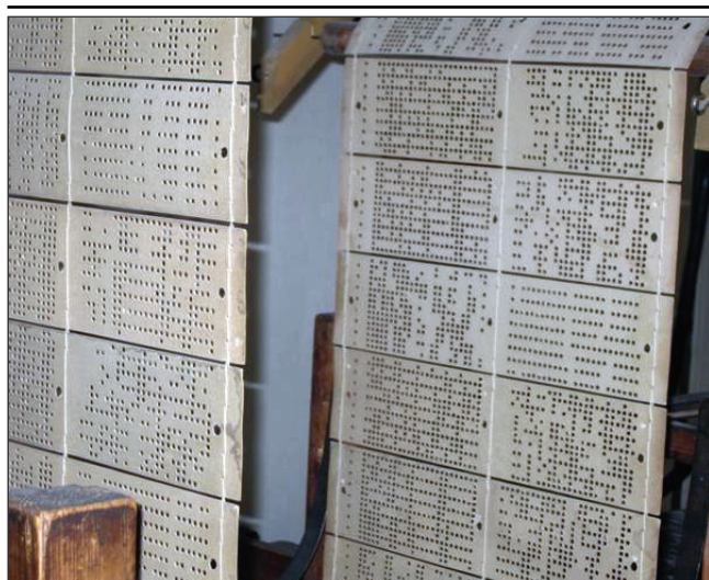
Рис. 3. Стрічка з перфокарт верстату Жаккарда
