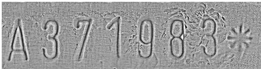
Рис. 2. Виявлення зміни у знаках методом магнітооптичної візуалізації
