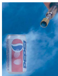
Рис. 9. Виявлення слідів пальців рук методом окурювання парами ціаноакрилу з використанням газового пальника
