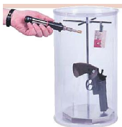
Рис. 8. Поліетиленова камера для обробки об'єктів парами ціаноакрилу з використанням газового пальника
