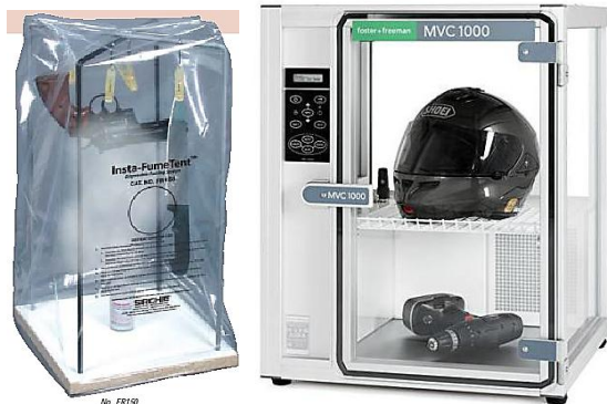
Рис. 7. У ціаноакрилових камерах без використання вакууму та з використанням вакууму.
