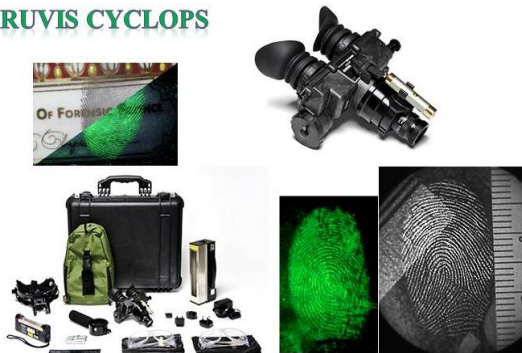
Рис. 3. Система RUVIS CYCLOPS для візуалізації слідів без попередньої їх обробки
