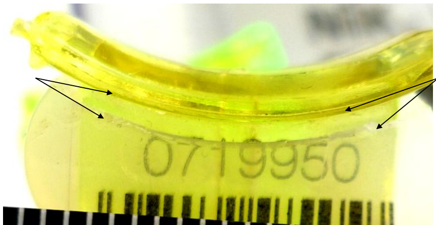
Рис.13. Вм'ятини на верхньому ребрі та кришці вставки полімерної пломби якірного типу.
