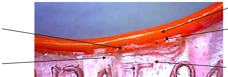
Рис. 5. Пошкодження на кришці вставки та торцевій поверхні корпусу об'єкта № 1.
